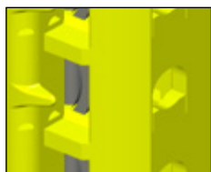
Clase de protección de los terminales IP20
